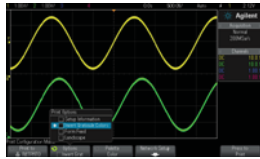
Не инвертированная координатная сетка
